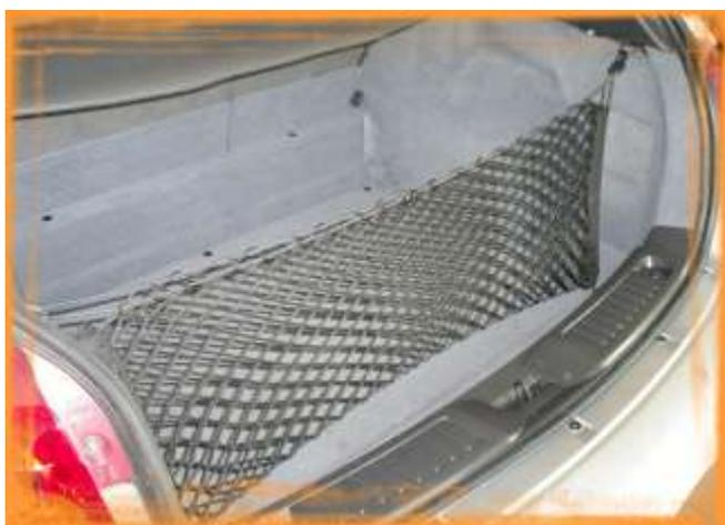
Das bivalente Kofferraumnetz kann sowohl auf dem Kofferraumboden, als auch als Sack an den Seiten überall dort befestigt werden, wo Ankerringe vorhanden sind, oder unter Verwendung des entsprechenden Bausatzes, erhältlich
